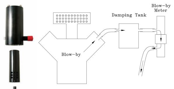
L'unità M400MR è facile da installare. Collegare un flessibile da 20 mm (3/4"), dal coperchio delle valvole del motore all'ingresso del misuratore. Collegare un secondo flessibile, dall'uscita del misuratore all'atmosfera.
